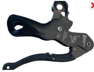
daño en palanca
