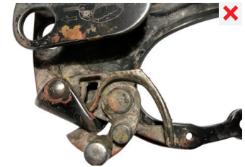
corrosión - funcionalidad limitada
