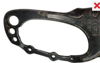
pérdida de asa
