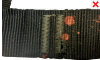
daño en costura de seguridad
