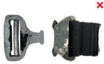
corrosión en hebilla tras salpicadura de material de construcción
