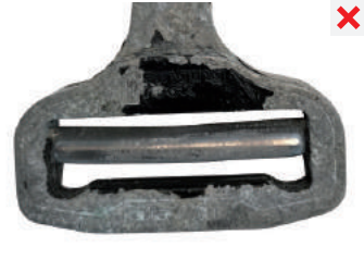
corrosión en hebilla tras salpicadura de material de construcción
