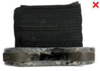
corrosión en hebilla causado por material de construcción
