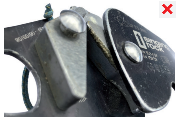
pérdida de material
