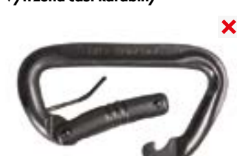
nefunkčnost zámku vytržená část karabiny
