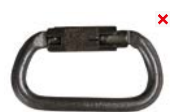
poškození neznámou chemikálií
