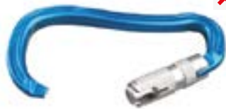
deformace a chybějící část karabiny
