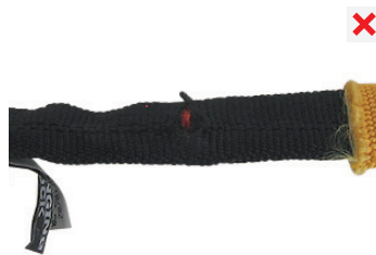
narušená konstrukce popruhu
