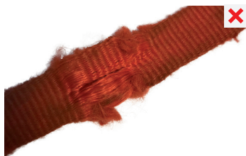
porušená struktura vláken
