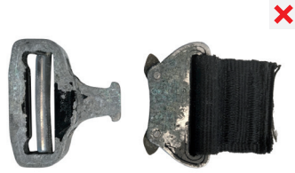
korozí spony při znečištění maltou
